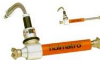
Rozpieracz RAM RA 3331+ - maksymalna siła rozciągania to 16,5 tony, maksymalna długość 962mm, maksymalna siła ciągnięcia 5 ton
